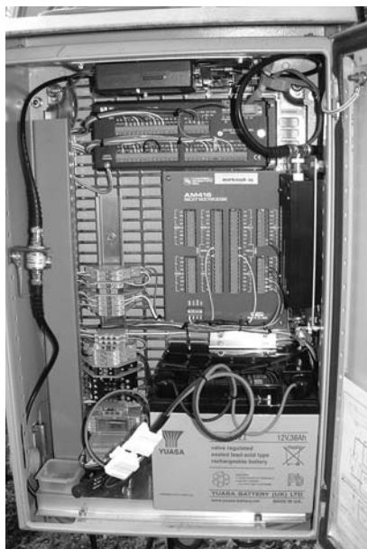
Abb. 3: Das Herzstück jeder Meteostation ist der Elektronikkasten mit den Energie-, Speicher- und Datenübertragungsmodulen.
